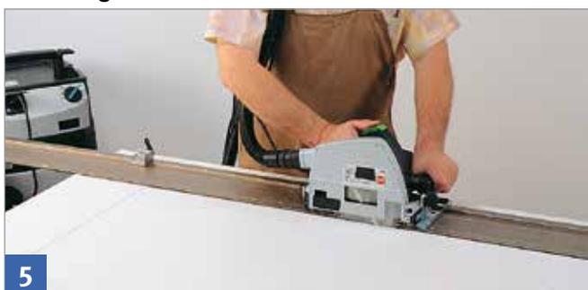
Tauchkreissäge verwenden; Spaltkeil entfernen, gegebenenfalls Spaltkeilhalterung festziehen; Führungsschiene auf Werkstück auflegen und festspannen; Anschlagnocken für Einsetzpunkt und Aussetzpunkt an der Führungsschiene befestigen.
