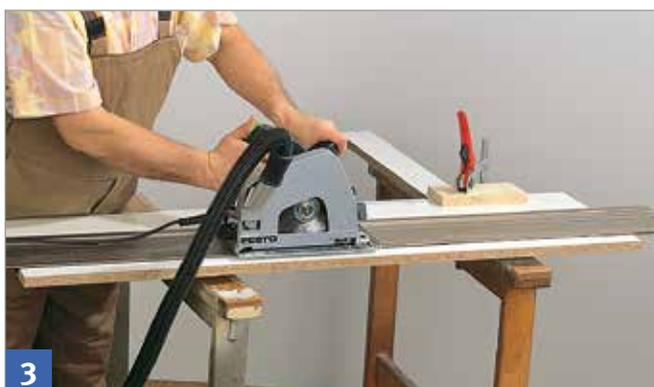
Kreissägeblatt für Plattenmaterial wählen (z. B. vielzahniges HW-Wechselzahn-Sägeblatt.)
