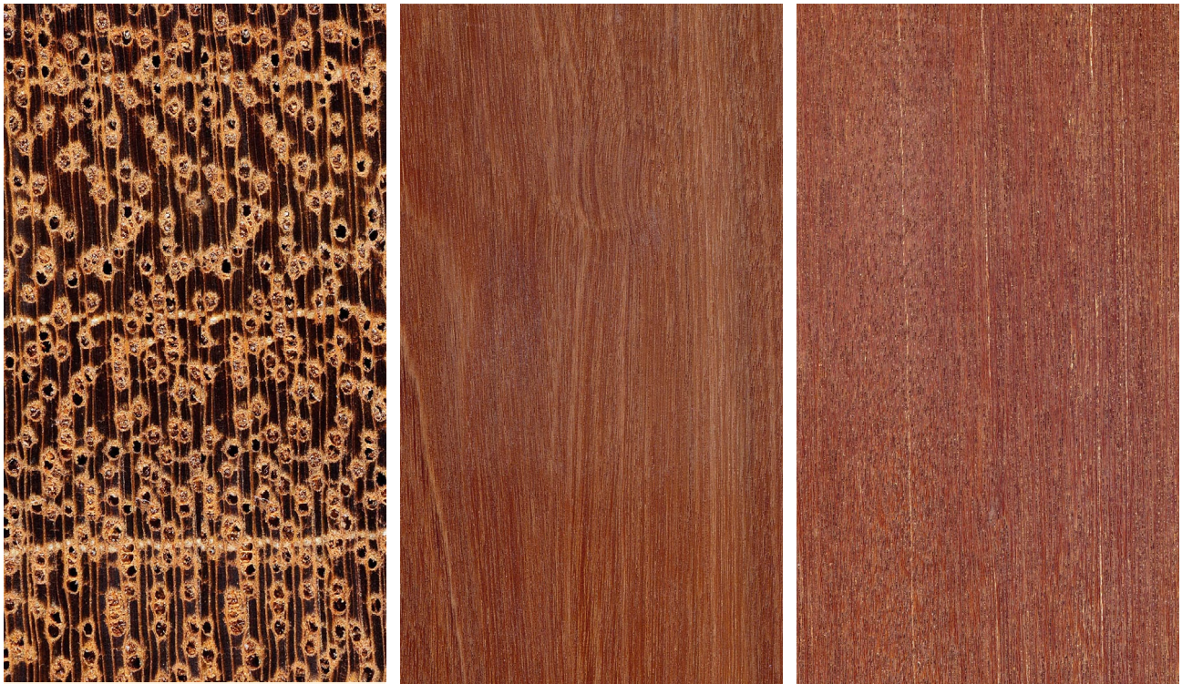
Red Balau ( Shorea sp.): Querschnitt (ca. 10x); tangentielle und radiale Oberfläche (natürliche Größe)
