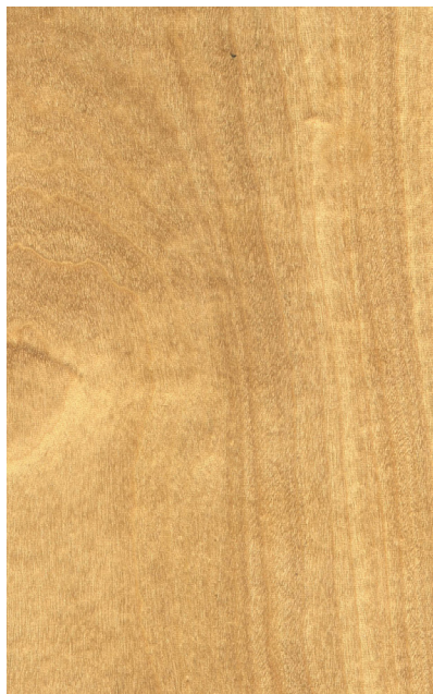
Ostindisches Satinholz ( Chloroxylon swietenia ): Querschnitt ca. 10x, tangentiale und radiale Oberfläche (natürliche Größe)
