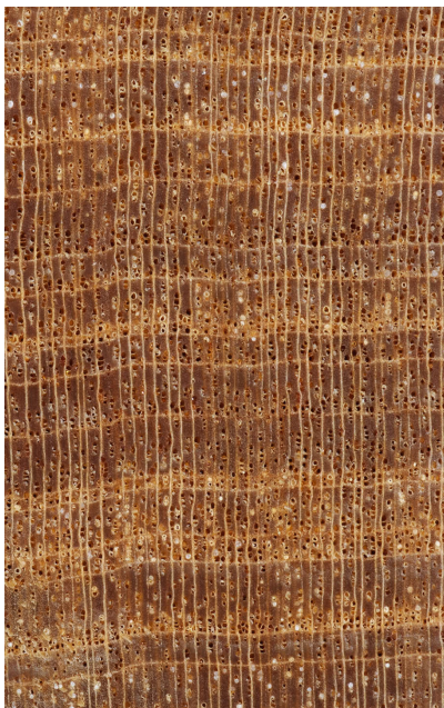
Ostindisches Satinholz ( Chloroxylon swietenia ): Querschnitt ca. 10x, tangentiale und radiale Oberfläche (natürliche Größe)
