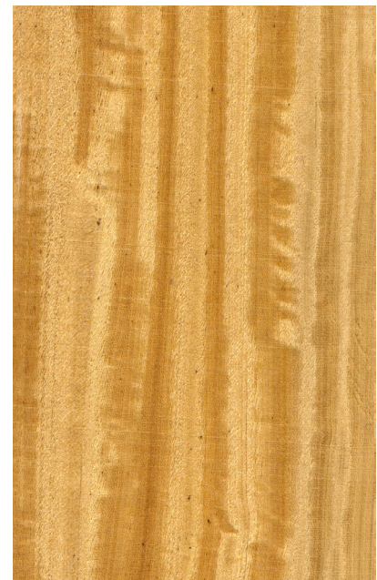
Ostindisches Satinholz ( Chloroxylon swietenia ): Querschnitt ca. 10x, tangentiale und radiale Oberfläche (natürliche Größe)
