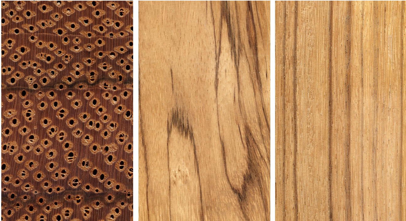
Ebiara ( Berlinia bracteosa ): Querschnitt ca. 10-x, tangentielle und radiale Oberfläche (natürliche Größe)
