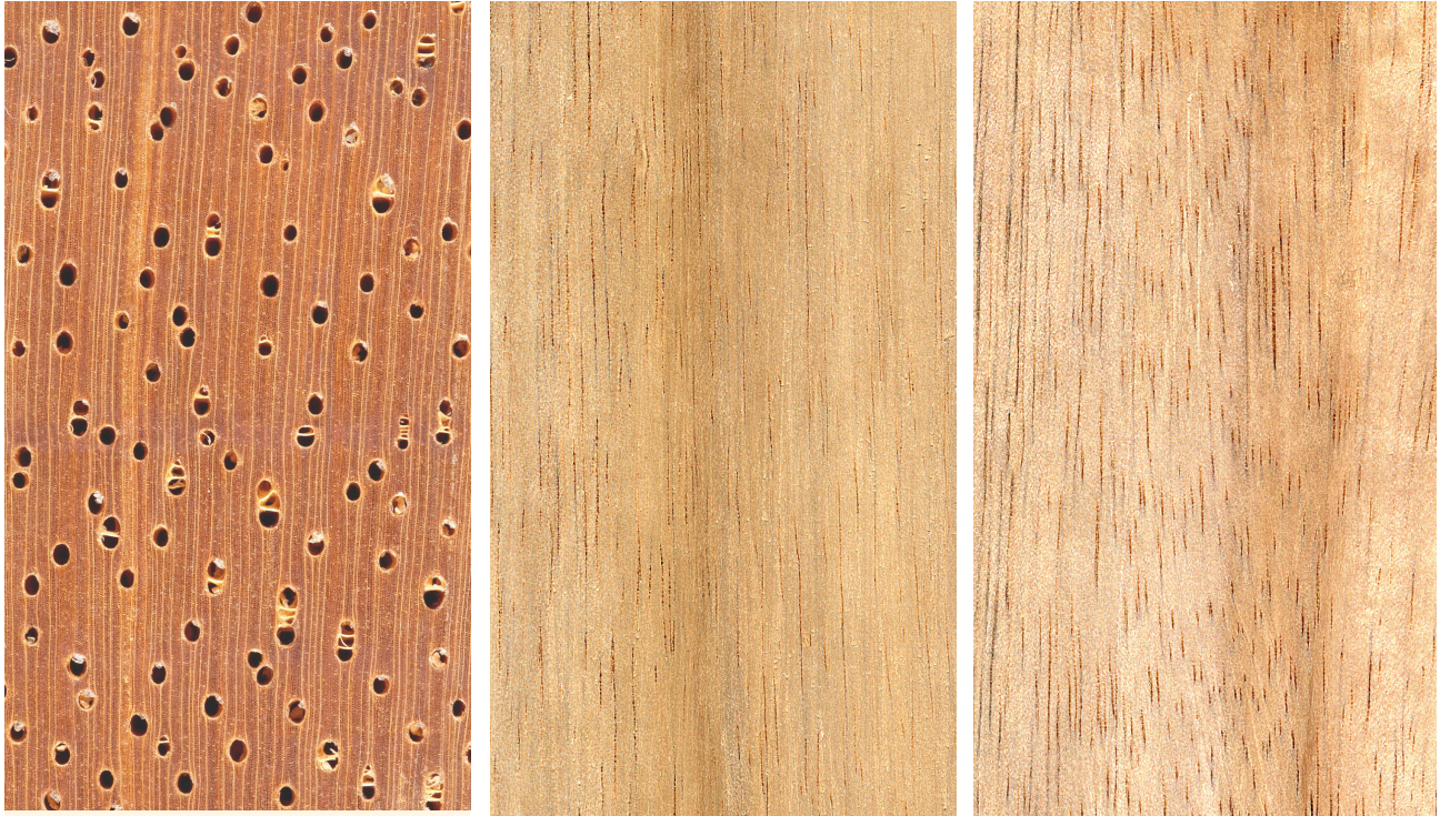
Batai ( Falcataria moluccana ): Querschnitt (ca. 10x), tangentielle und radiale Oberfläche (natürliche Größe)
