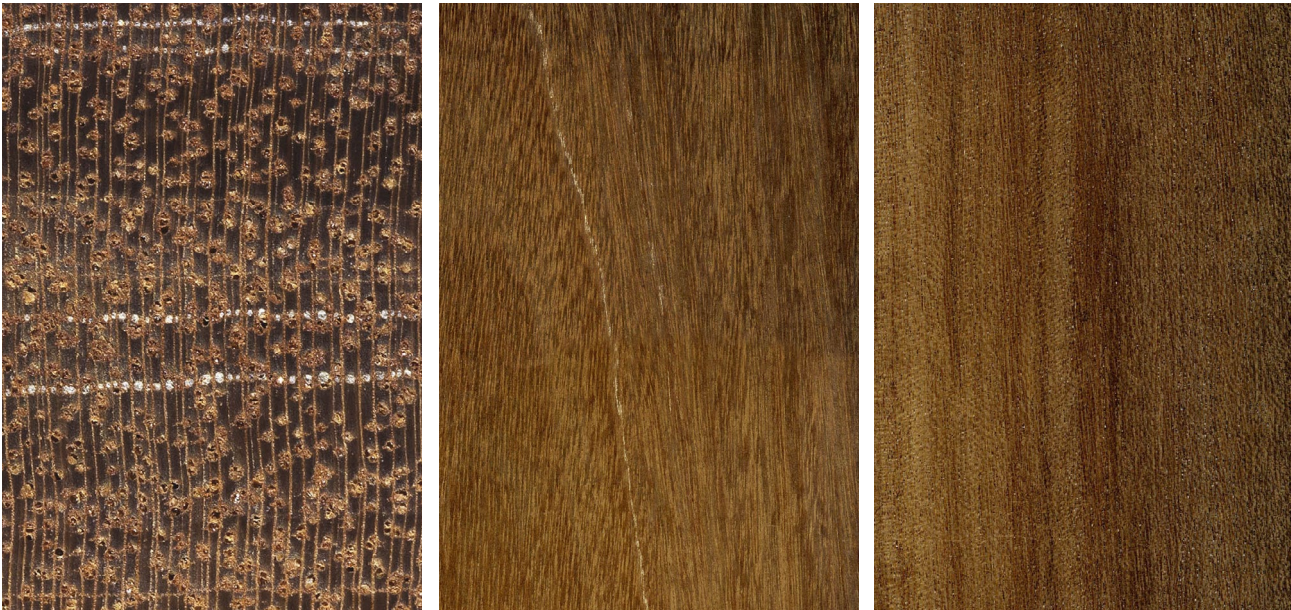
Giam ( Hopea spp.) Querschnitt (ca. 10x), tangentielle und radiale Oberfläche (natürliche Größe)
