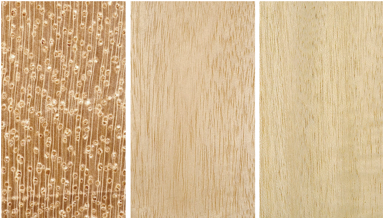
Melina ( Gmelina arborea ): Querschnitt (ca. 10x), tangentielle und radiale Oberfläche (natürliche Größe)
