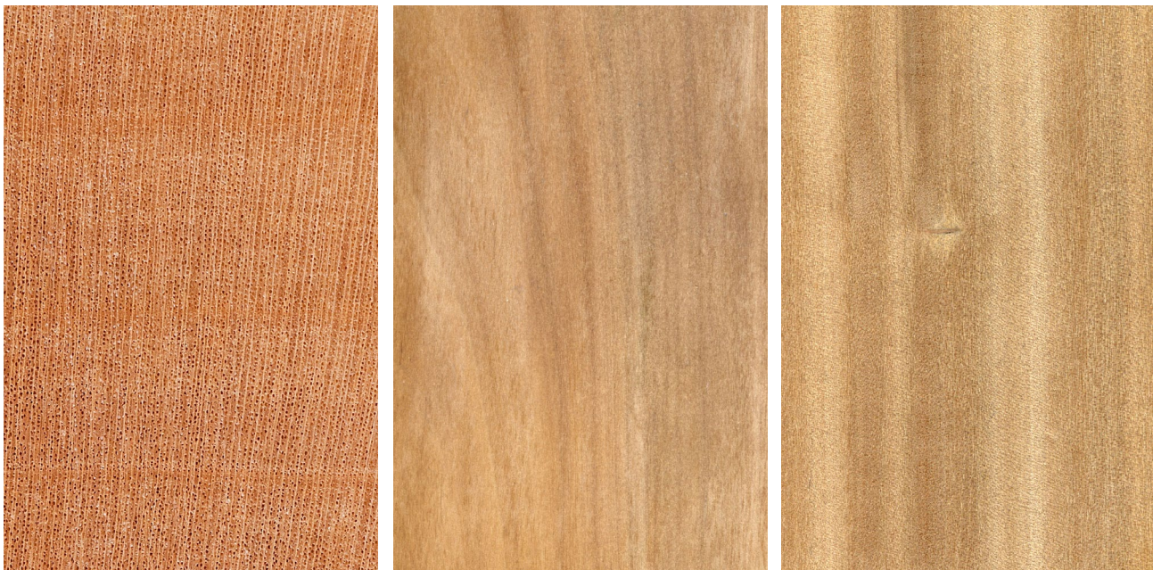
Schima ( Schima wallichii ) Querschnitt (ca. 10x), tangentielle und radiale Oberfläche (natürliche Größe)
