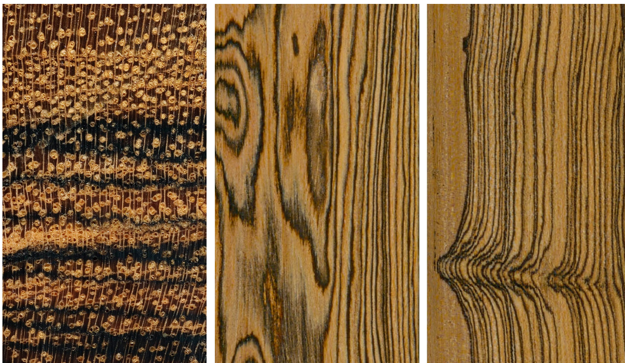
Barcino ( Cordia elaeagnoides ): Querschnitt ca. 10x, tangentiale und radiale Oberfläche (natürliche Größe)
