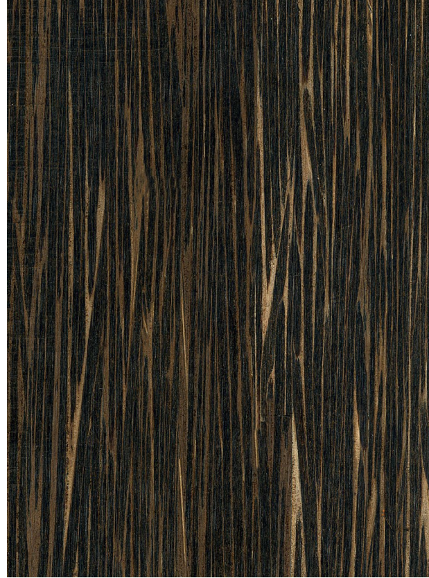
Black palm ( Iriartea deltoidea ): Querschnitt einer Lamelle in natürlicher Größe (links oben), etwa 10x vergrößert (blockverleimt, links unten); Oberfläche in natürlicher Größe (rechts)
