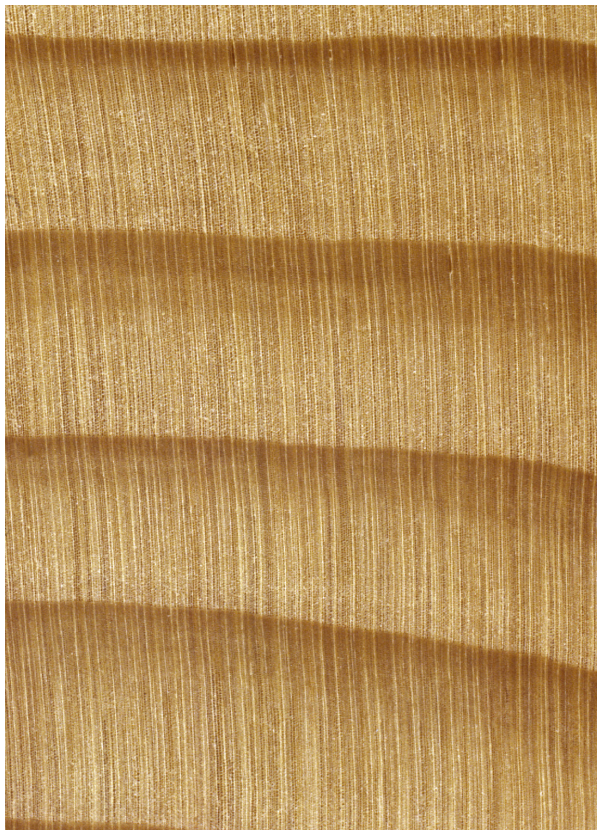
Weißtanne ( Abies alba ): Querschnitt (ca. 12x) und radiale Oberfläche (natürliche Größe)
