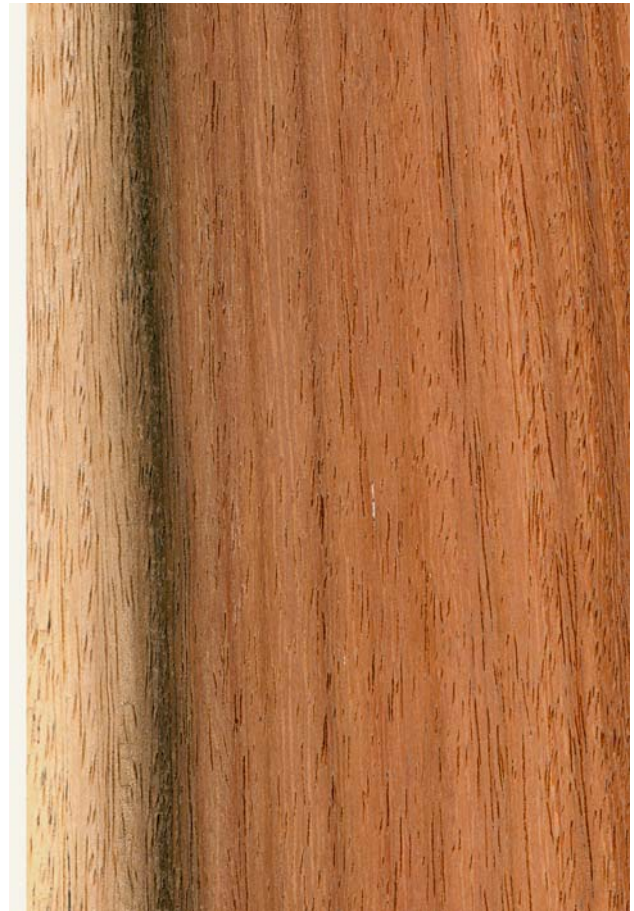
Machiche ( Lonchocarpus cf. castilloi ): Querschnitt (ca. 12x) und radiale Oberfläche (natürliche Größe)
