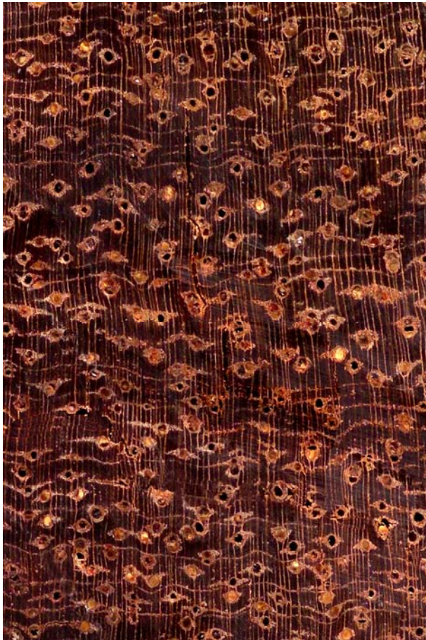
Granadillo ( Platymiscium cf. yucatanum ): Querschnitt (ca. 12x) und radiale Oberfläche (natürliche Größe)
