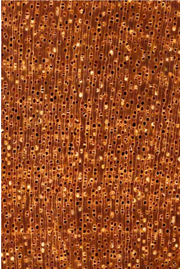
Chakté-viga ( Caesalpinia platyloba ): Querschnitt (ca. 12x) und radiale Oberfläche (natürliche Größe)
