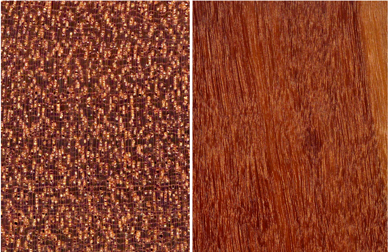
Massaranduba ( Manilkara sp.): Querschnitt (ca. 12x) und tangentiale Oberfläche (natürliche Größe)
