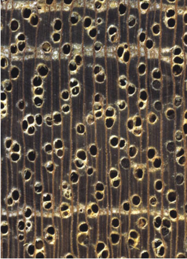
White Seraya ( Parashorea spp.): Querschnitt (ca. 12x) und tangentiale Oberfläche (nat. Größe)
