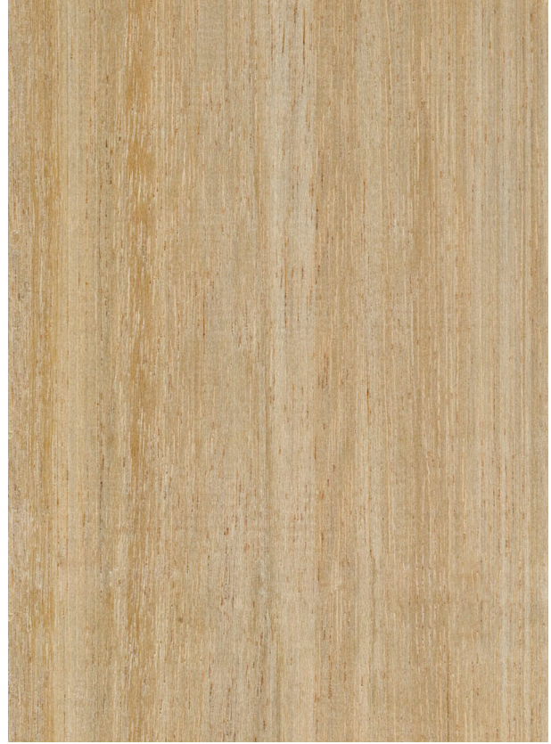
White Seraya ( Parashorea spp.): Querschnitt (ca. 12x) und tangentiale Oberfläche (nat. Größe)
