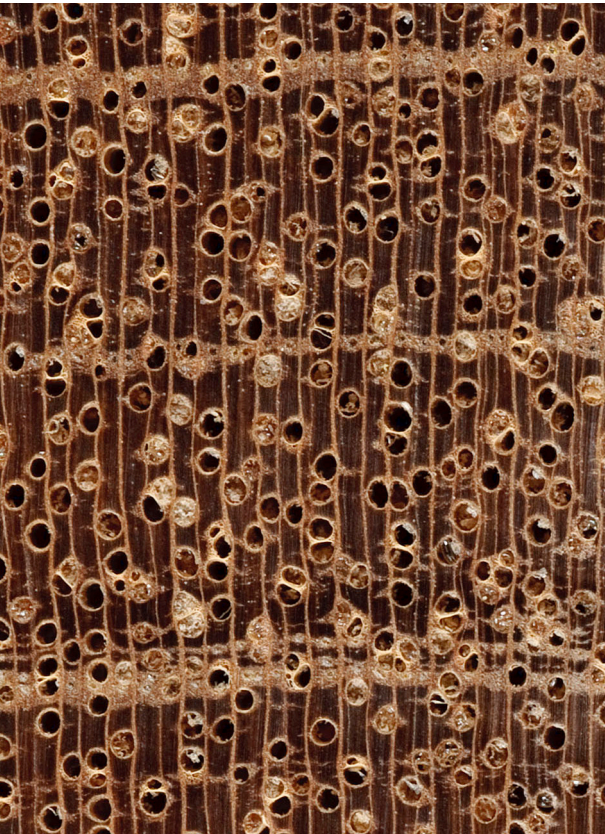
Gerutu ( Parashorea spp.): Querschnitt (ca. 12x) und tangentiale Oberfläche (nat. Größe)
