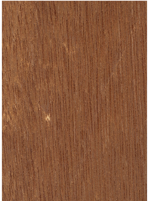
Gerutu ( Parashorea spp.): Querschnitt (ca. 12x) und tangentiale Oberfläche (nat. Größe)
