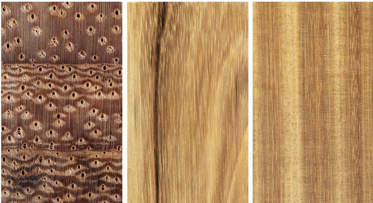
Naga ( Brachystegia spp.): Querschnitt ca. 10-x, tangentielle und radiale Oberfläche (natürliche Größe)
