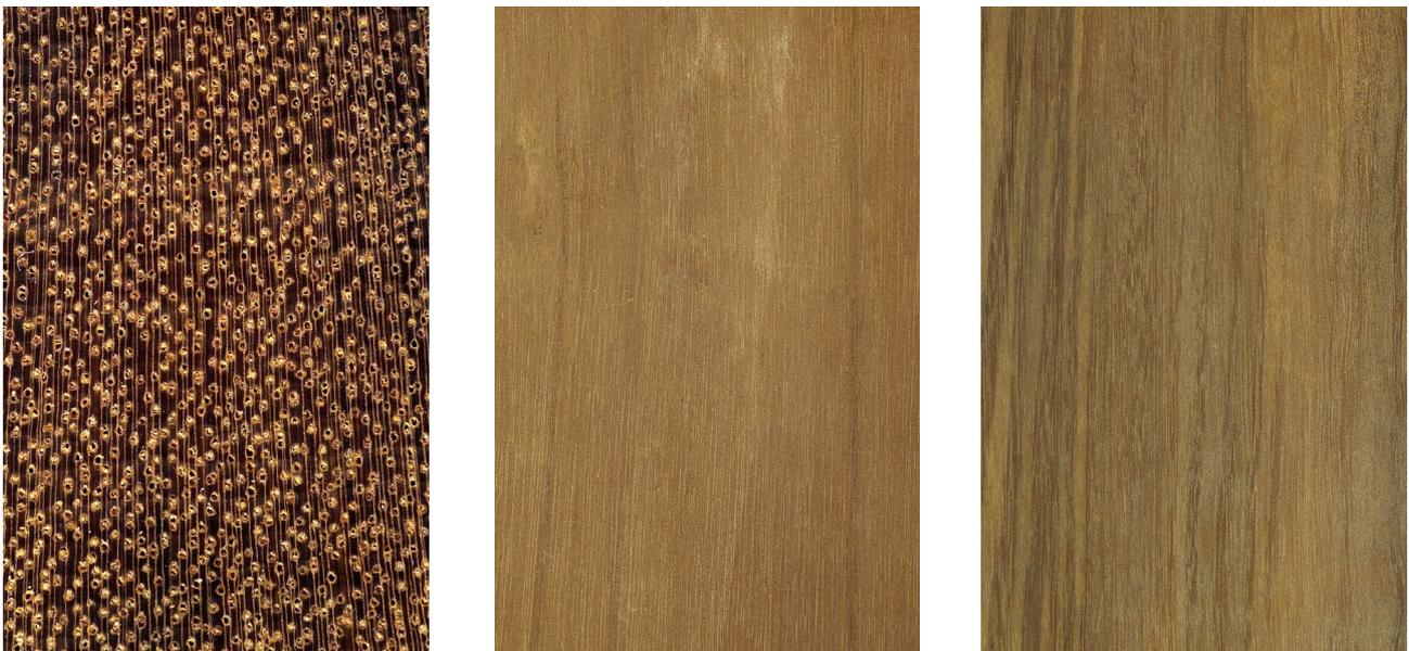
Greenheart (*Chlorocardium rodiei*): Querschnitt (ca. 10x); tangentielle und radiale Oberfläche (natürliche Größe)
