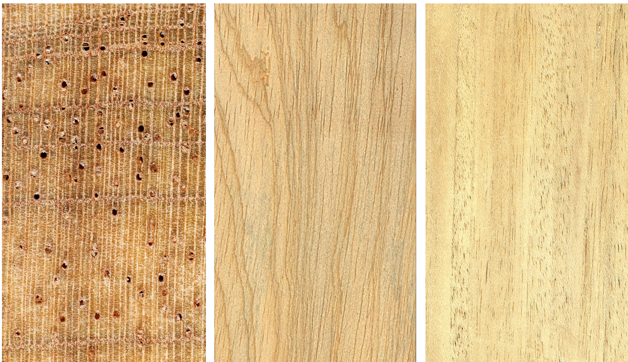
Ceiba ( Ceiba pentandra ): Querschnitt (ca. 10x), tangentielle und radiale Oberfläche (natürliche Größe)
