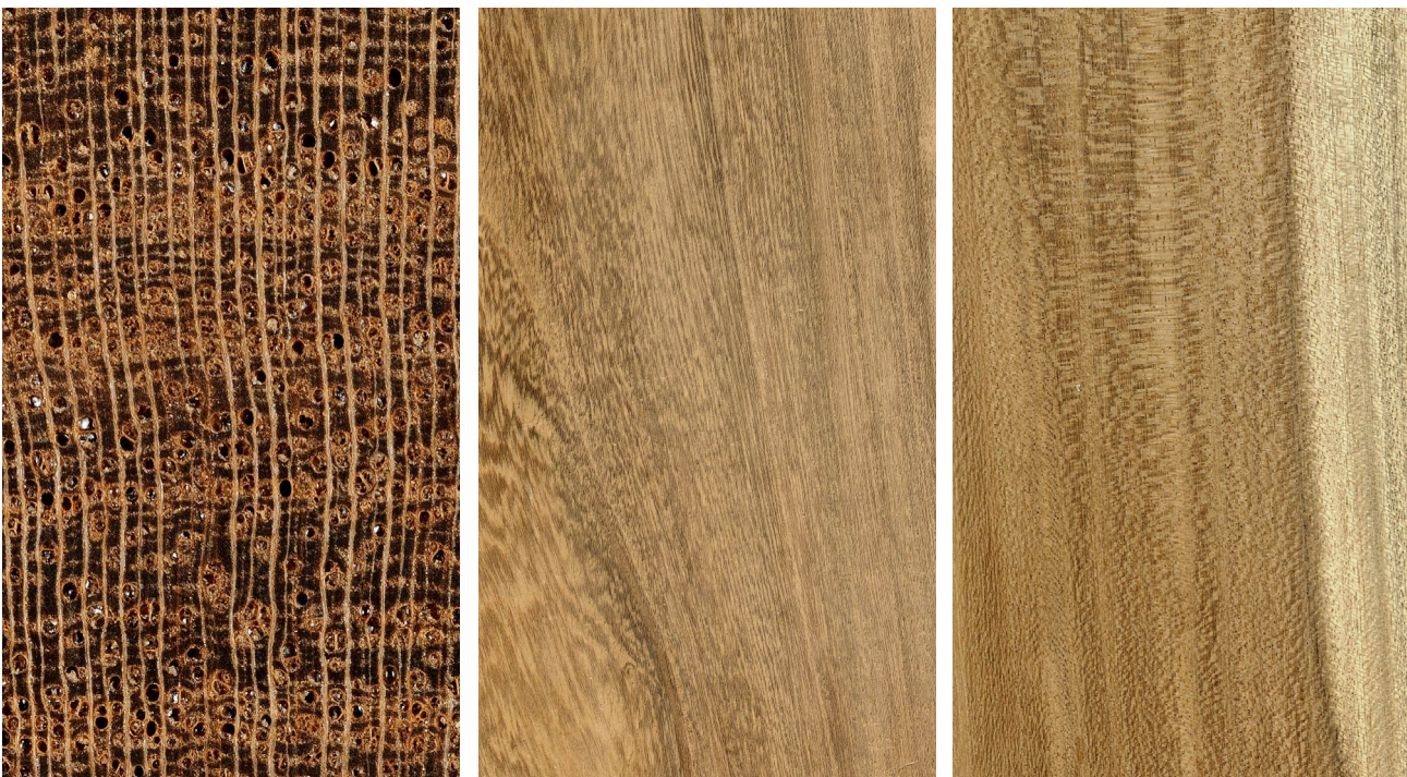
Afrikanisches Cordia ( Cordia africana ) Querschnitt (ca. 10x), tangentielle und radiale Oberfläche (natürliche Größe)
