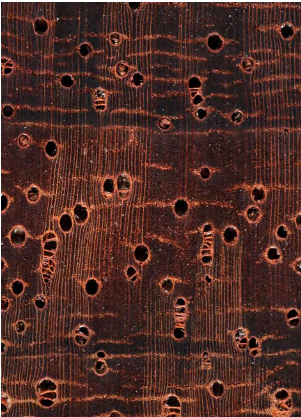
Padouk ( Pterocarpus soyauxii ): Querschnitt (ca. 12x) und radiale Oberfläche (nat. Größe)
