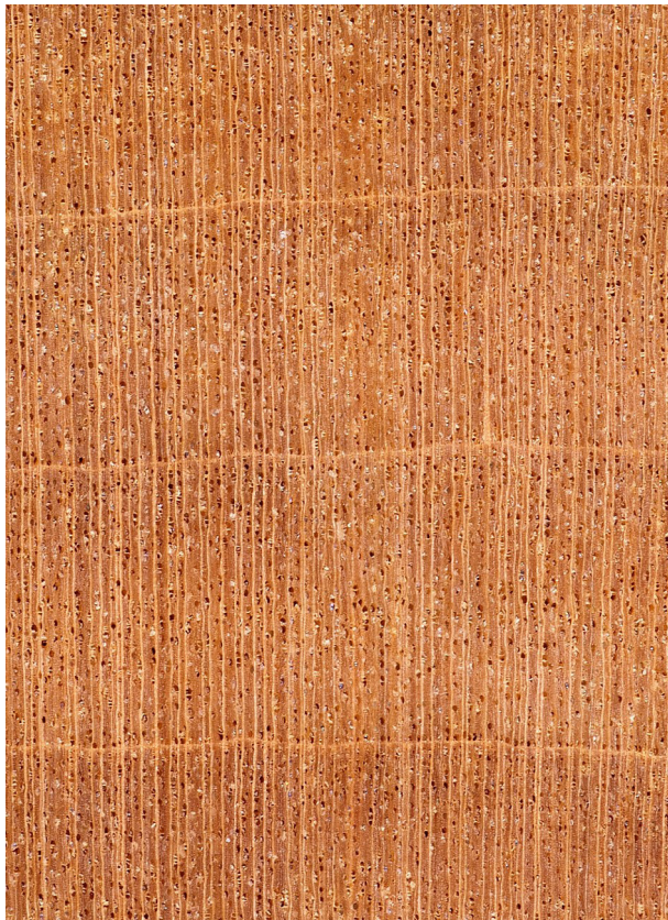
Lenga ( Nothofagus pumilio ): Querschnitt (ca. 12x) und tangentielle Oberfläche (natürliche Größe)
