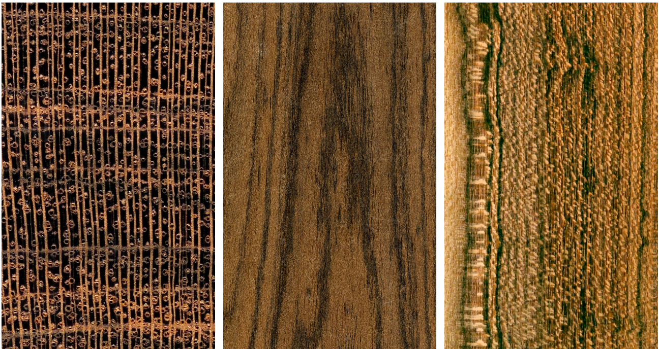
Louro preto ( Cordia glabrata ): Querschnitt (ca. 10x); tangentielle und radiale Oberfläche (natürliche Größe)
