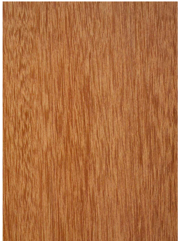
Kapur ( Dryobalanops spp.): Querschnitt (ca. 12x) und tangentiale Oberfläche (natürliche Größe)
