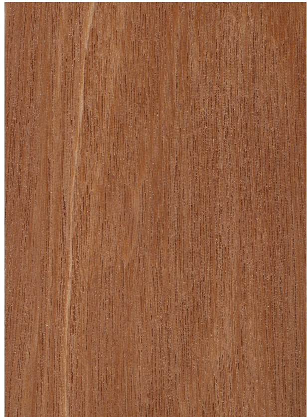
Keruing ( Dipterocarpus spp.): Querschnitt (ca. 12x) und tangentielle Oberfläche (natürliche Größe)
