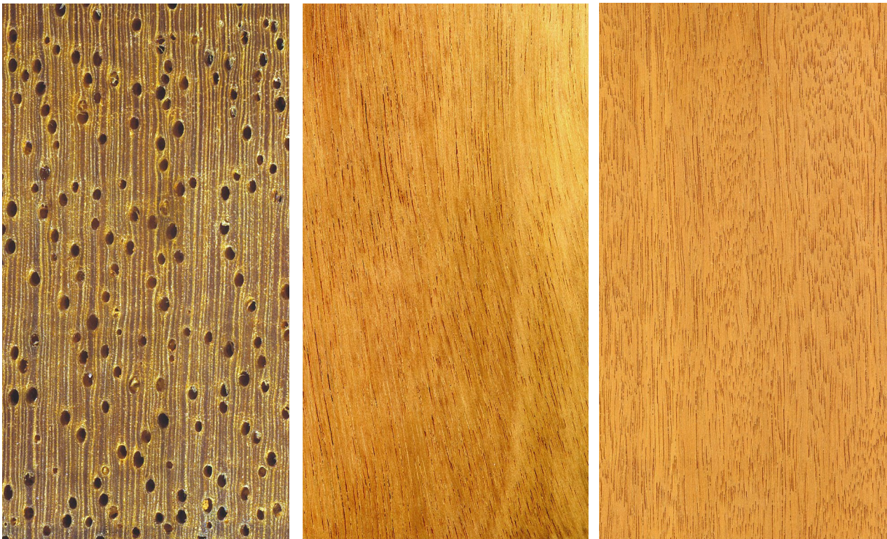
Bilinga ( Nauclea diderrichii ) Querschnitt (ca. 12x), tangentielle und radiale Oberfläche (natürliche Größe)
