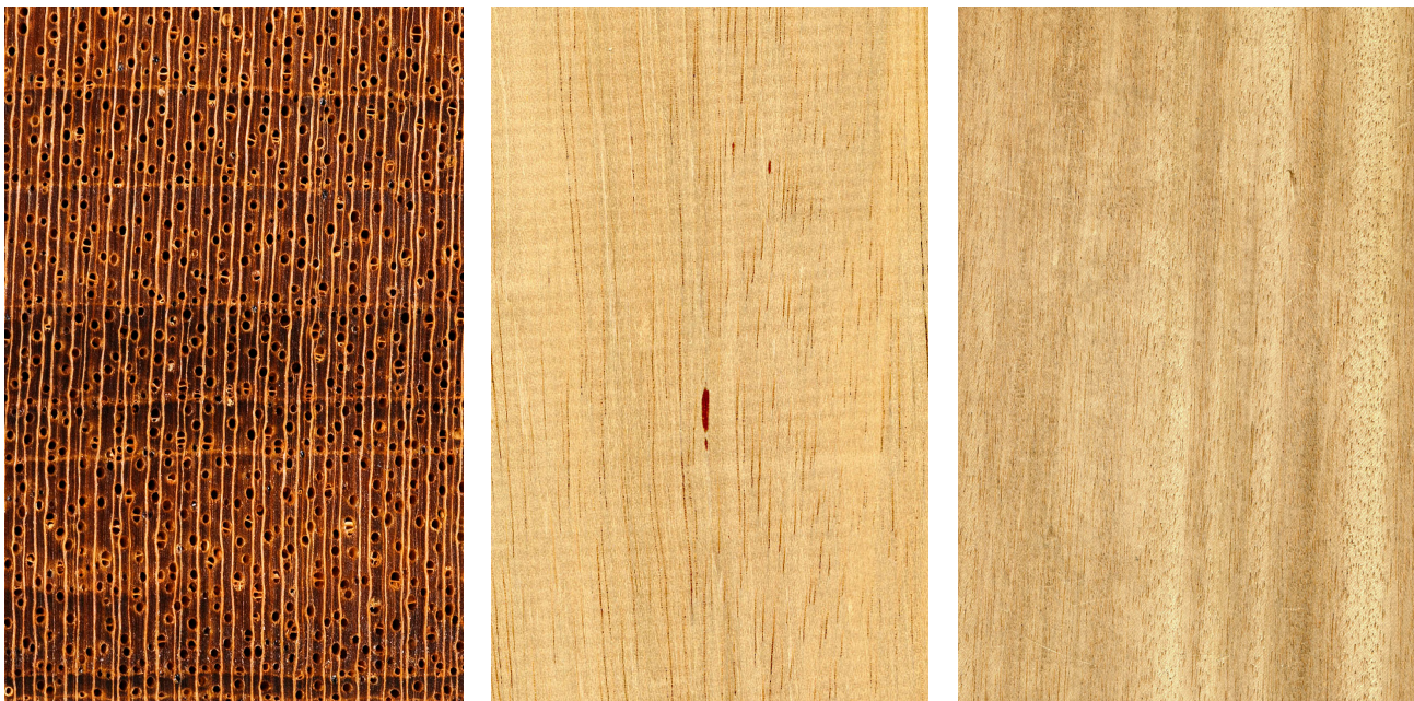
Agba ( Gossweilerodendron balsamiferum ): Querschnitt (ca. 10x), tangentielle und radiale Oberfläche (natürliche Größe)
