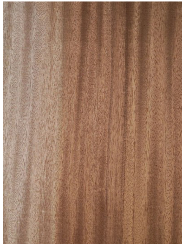
Tiama ( Entandrophragma angolense ): Querschnitt (ca. 12x) und radiale Oberfläche (nat. Größe)
