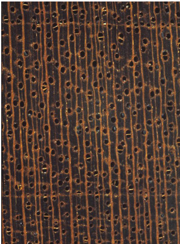
Tiama ( Entandrophragma angolense ): Querschnitt (ca. 12x) und radiale Oberfläche (nat. Größe)
