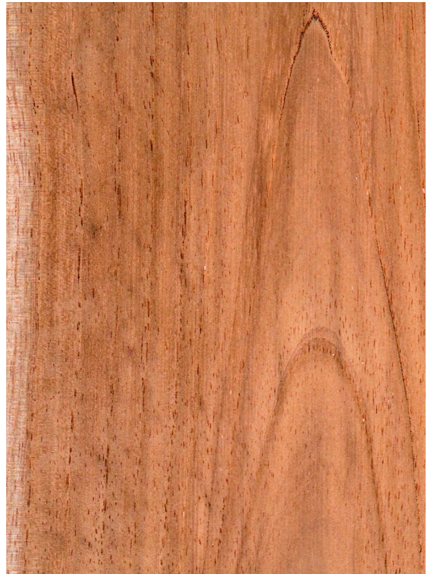
Cedro ( Cedrela spp.): Querschnitt (ca. 12x) und tangentielle Oberfläche (natürliche Größe)
