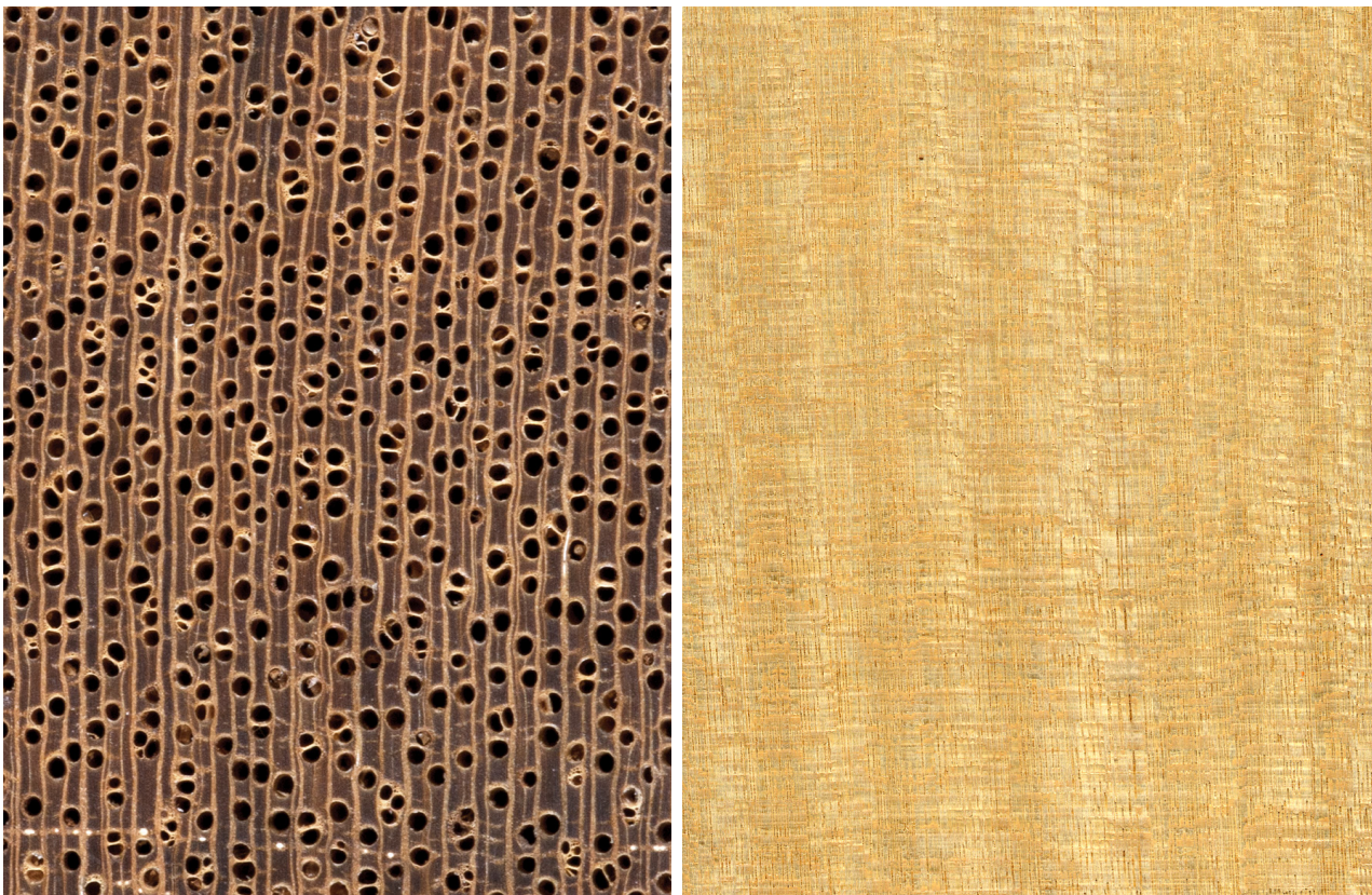
Gelbes Meranti ( Shorea sp.): Querschnitt (ca. 12x) und radiale Oberfläche (natürliche Größe)
