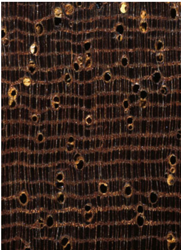
Azobé, ( Lophira alata ): Querschnitt (ca. 12x) und tangentiale Oberfläche (natürliche Größe)
