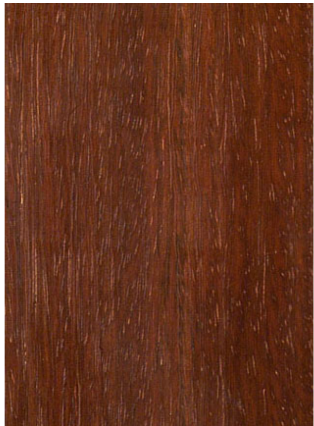
Azobé, ( Lophira alata ): Querschnitt (ca. 12x) und tangentiale Oberfläche (natürliche Größe)
