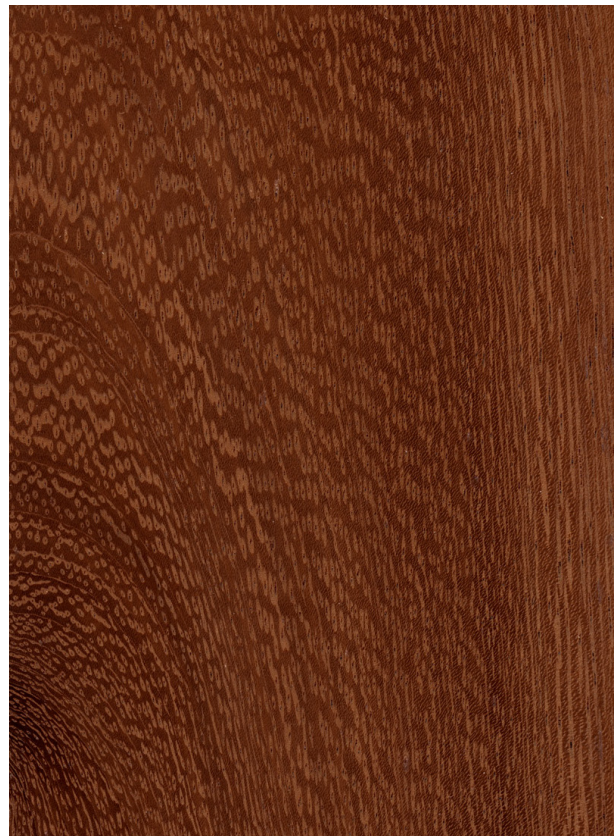
Afzelia ( Afzelia spp.): Querschnitt (ca. 12x) und tangentielle Oberfläche (natürliche Größe)
