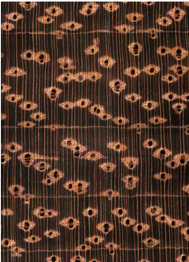
Afzelia ( Afzelia spp.): Querschnitt (ca. 12x) und tangentielle Oberfläche (natürliche Größe)
